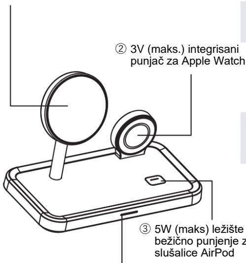
④ LED indikator punjenja (automatski se isključuje nakon 20 sekundi)
